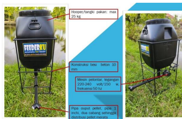
Gambar 1. Inovasi Feederku berbasis komponen lokal
