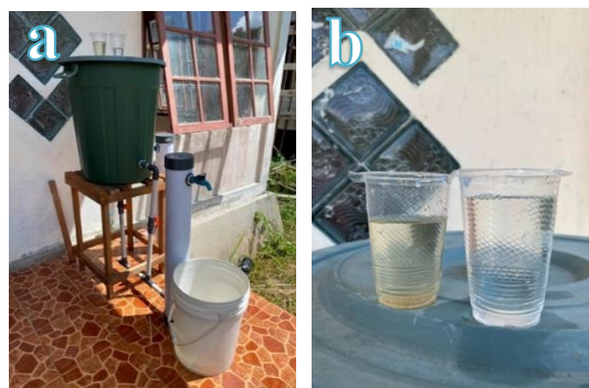
Gambar 3. Proses pengolahan air bersih; (a) rangkaian alat pengolahan air bersih, (b) hasil pengolahan air bersih sebelum dan sesudah.
