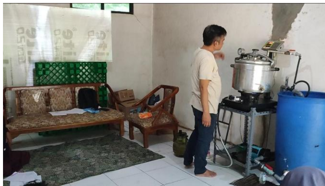
Gambar 1. Mesin vakum evaporasi tekanan rendah
