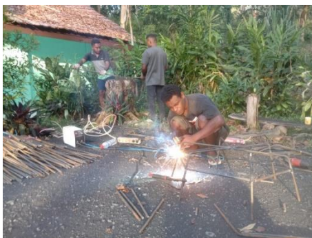
Gambar 3. Proses pengelasan rangka besi media transplantasi.
