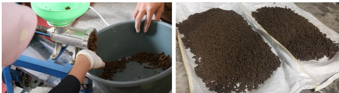
Gambar 3. Foto demonstrasi pembuatan pelet pakan lele dari kotoran puyuh
