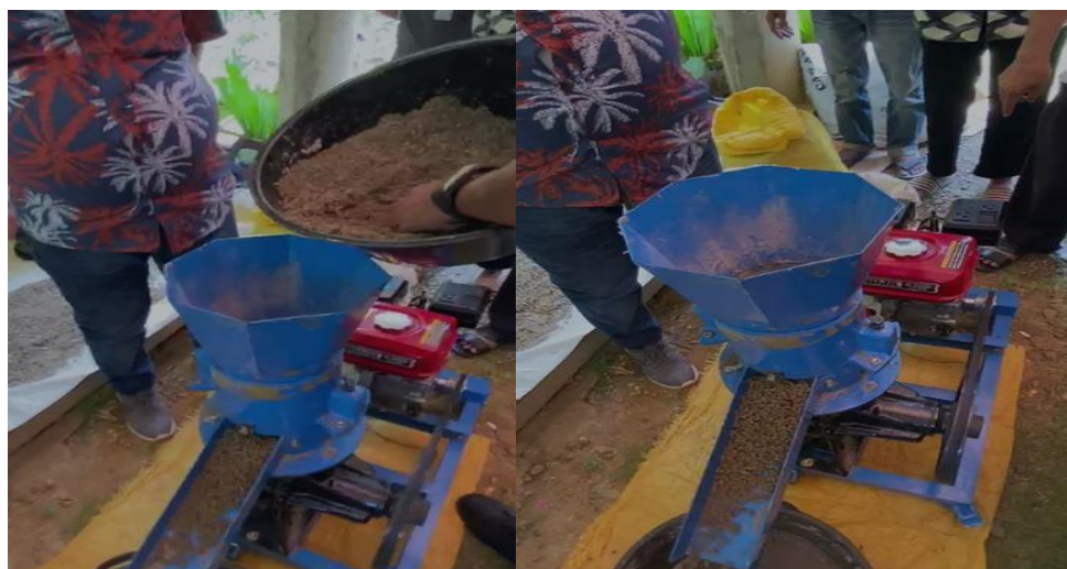
Gambar 8. Proses mencetak pakan berbentuk pellet menggunakan mesin cetak vertikal pellet
